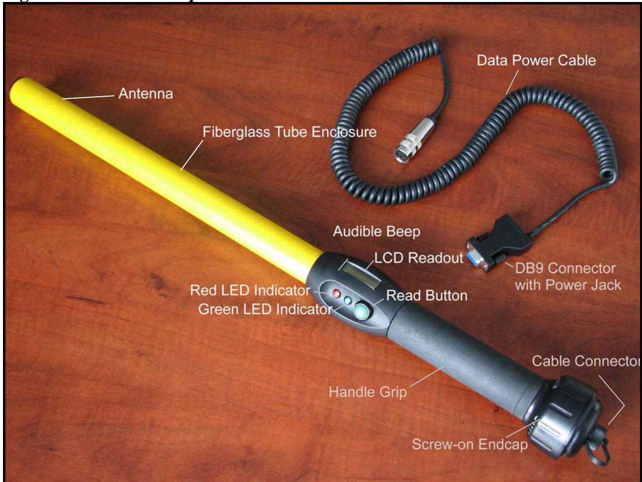
Figure 1 – Caractéristiques du Stick Reader et interface utilisateur
